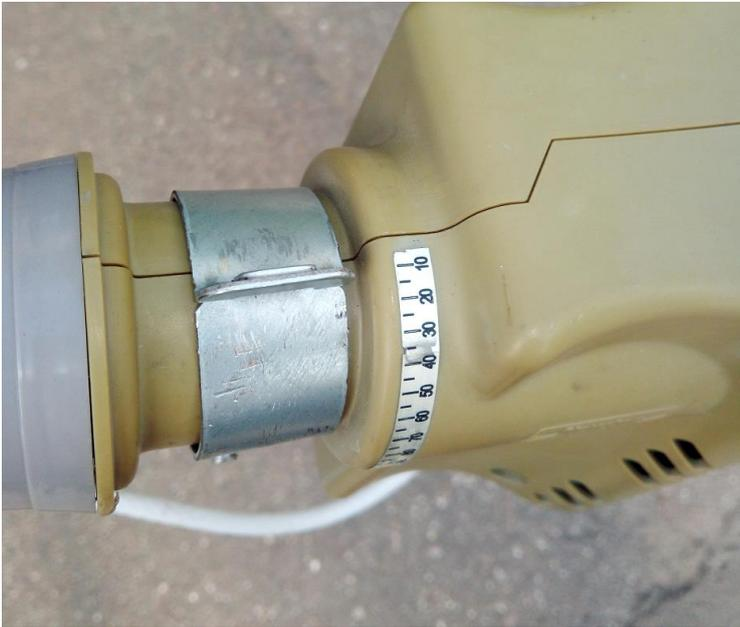
Угол разворота конвертора iLNB (LNB Skew, угол КПР) вы уже должны были заранее определить на сайте <http://www.dishpointer.com/>. Обратите внимание на знак «+» или «-» перед значением угла КПР. Установите конвертор iLNB на соответствующий угол.
