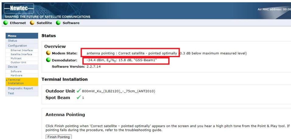
Добиться повышения уровня сигнала можно также, немного скорректировав угол КПР поворотом конвертора iLNB. Поворачивать конвертор надо очень аккуратно, по 1 градусу. После каждого смещения необходимо проверять уровень сигнала в web-интерфейсе. При смещении вы должны избегать воздействия крутящего момента непосредственно на штангу держателя конвертора. После выставления конвертора на максимум уровня сигнала- затяните болт фиксации конвертора в держателе.
