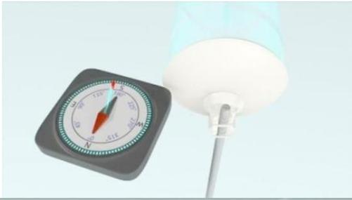
После того как параметры для наведения антенны определены, можно перейти к выбору места установки на конкретном объекте. При помощи компаса определите направление, в котором должна быть сориентирована антенна.
