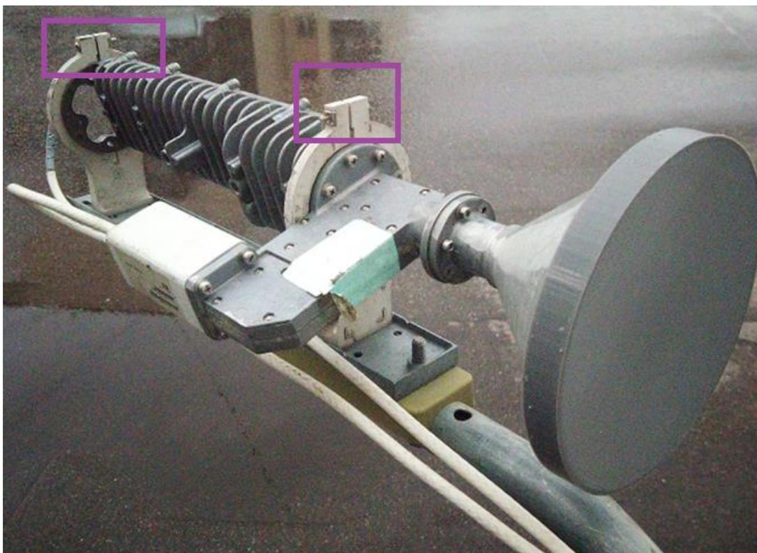
Ослабьте винты фиксации поворота приемопередатчика и скорректируйте угол КПР в соответствии с разницей значения параметра **LNB Skew**, взятого для спутников Э-103 и Э-80 на сайте <http://www.dishpointer.com/>
