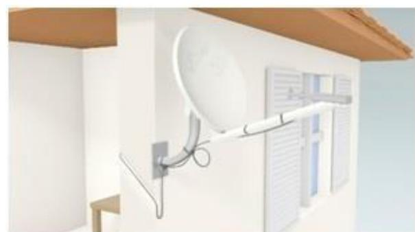
Сверление отверстия для ввода кабелей производите под наклоном, для предотвращения попадания влаги внутрь помещения. При вводе кабелей в помещение не забудьте оставить «конденсатную» петлю.
