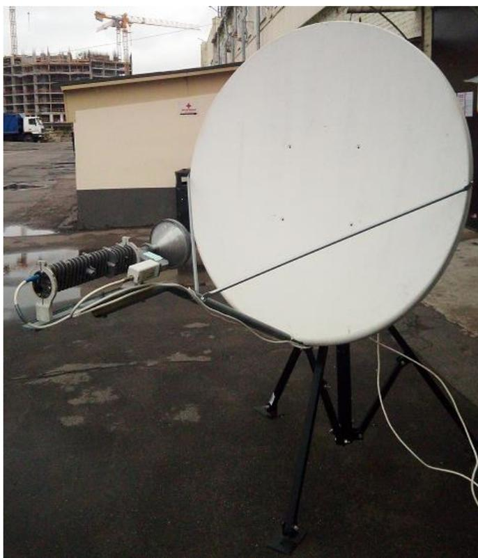
Предварительное ориентирование установленного на антенне приемопередатчика осуществляется по-разному, в зависимости от его типа. Тип приемопередатчика можно легко определить по его внешнему виду.
